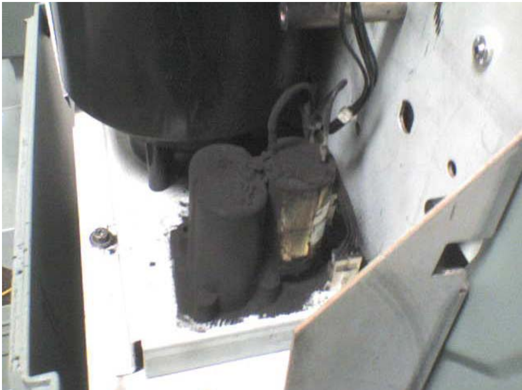
Abbildung 5 Geöffneter Plotter mit Tonerablagerungen
