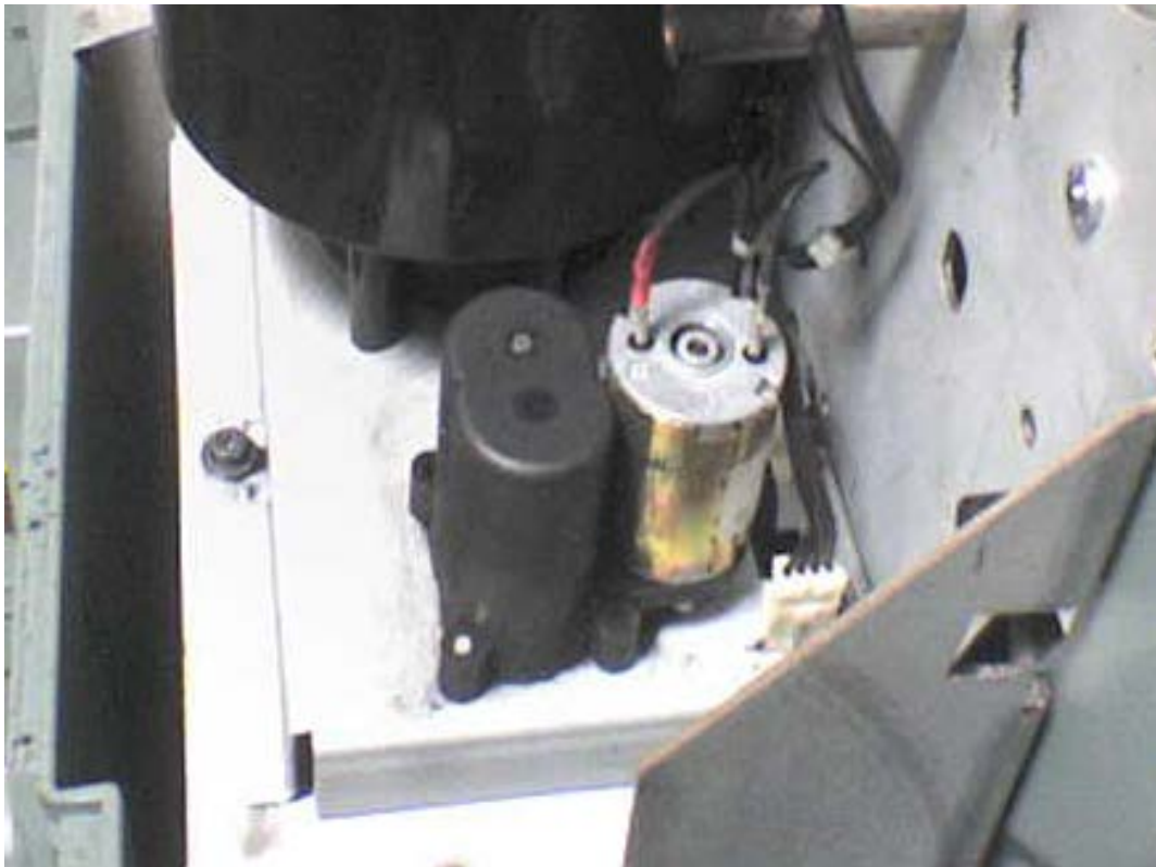
Abbildung 6 Geöffneter Plotter nach der Entfernung der Tonerablagerungen
