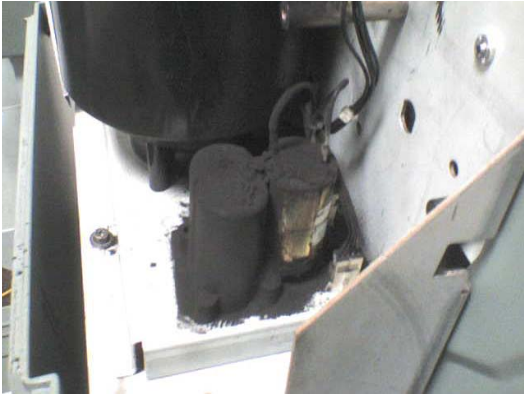
Abbildung 5 Geöffneter Plotter mit Tonerablagerungen
