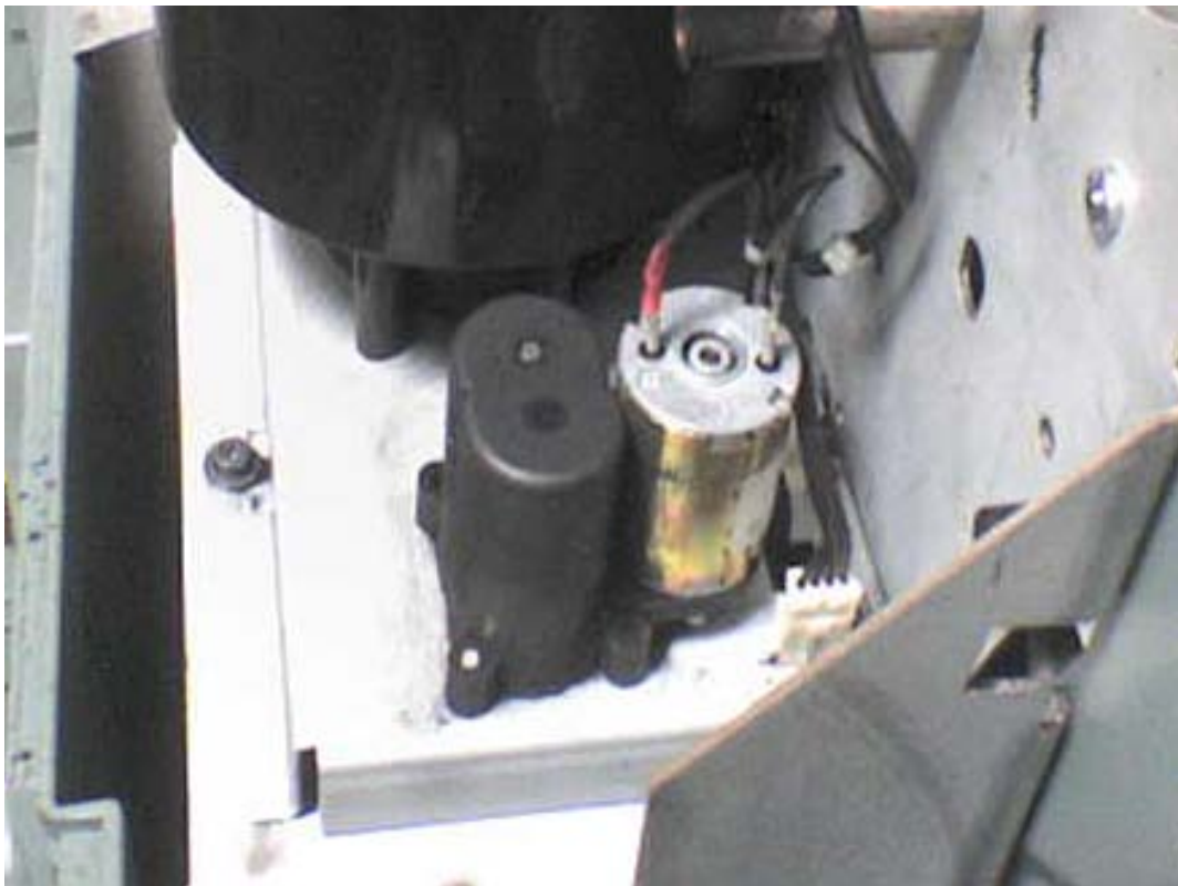
Abbildung 6 Geöffneter Plotter nach der Entfernung der Tonerablagerungen
